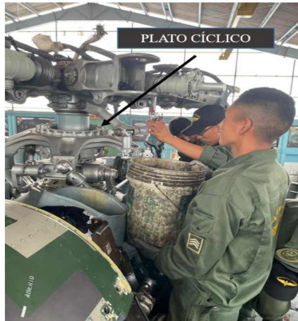
Figura 2. Verificando torque de perno.
