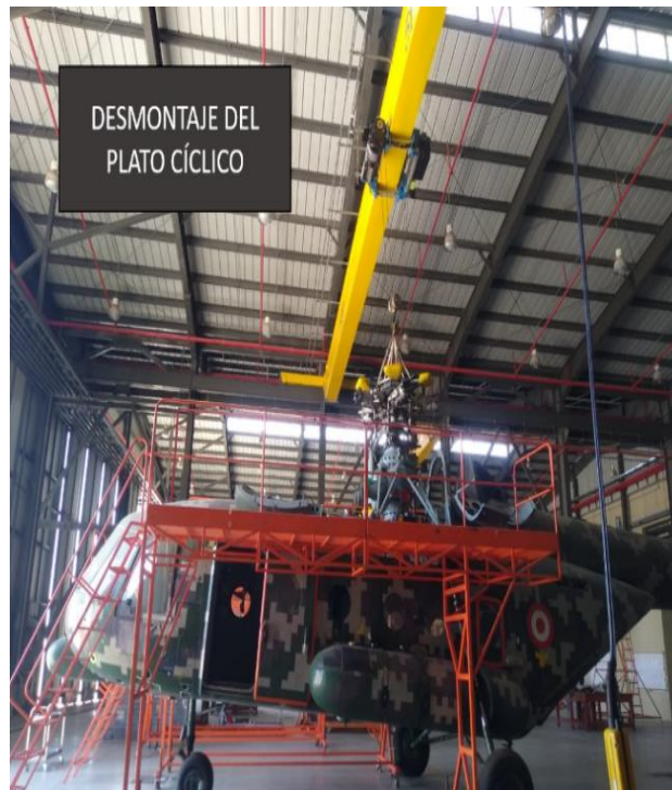
Figura 3. Desmontaje del plato cíclico.
