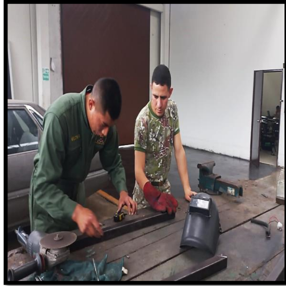
Figura11. Soldadura de las piezas metálicas
