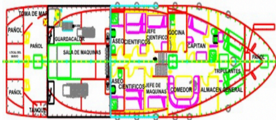
Figura 10. Organización de una Cubierta
