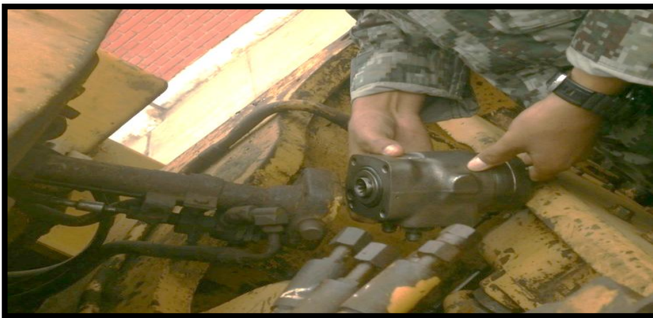
Figura 22: Conjunto orbitrol cubierto de óxido así como el eje de la volante de dirección.
