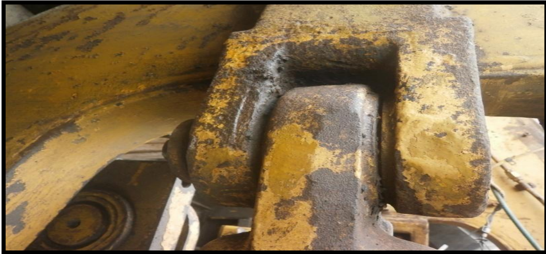
Figura 28: Unión de los cilindros de dirección carcomidos por el óxido.
