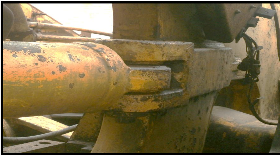
Figura 26: Puntos de engrase sin grasa cubiertos de agentes contaminantes.
