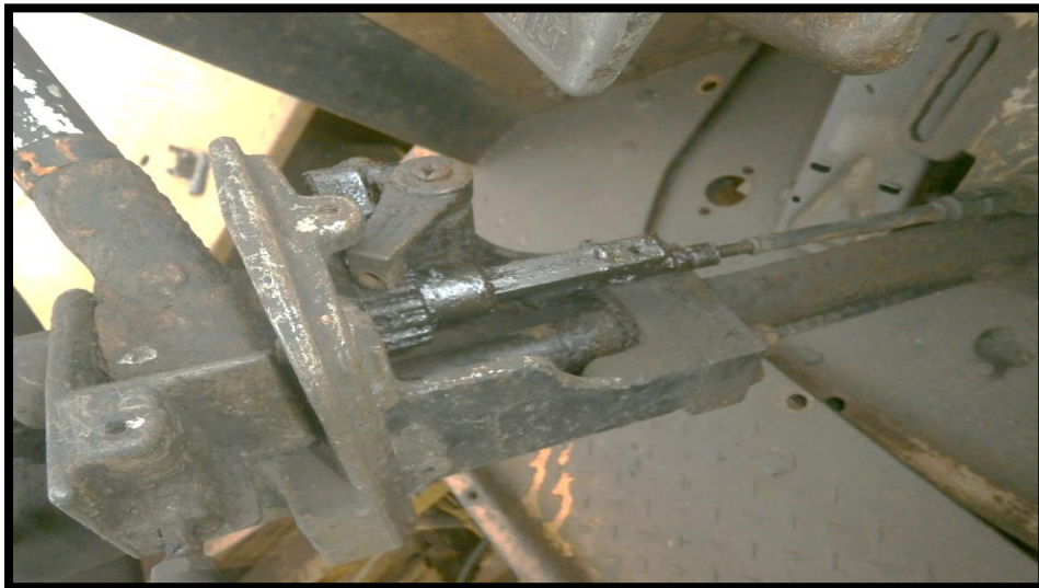
Figura 24: Mecanismos de transmisión de la dirección sin lubricación y suciedad.
