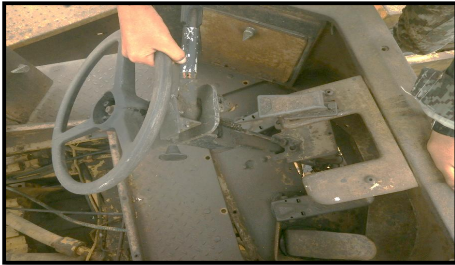
Figura 23: Volante de dirección rota y fuera de su lugar, cubierta de óxido.
