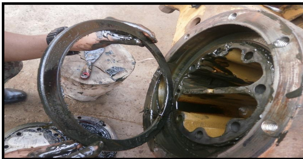
Figura 33: Discos con desgaste y corroídos de óxido.
