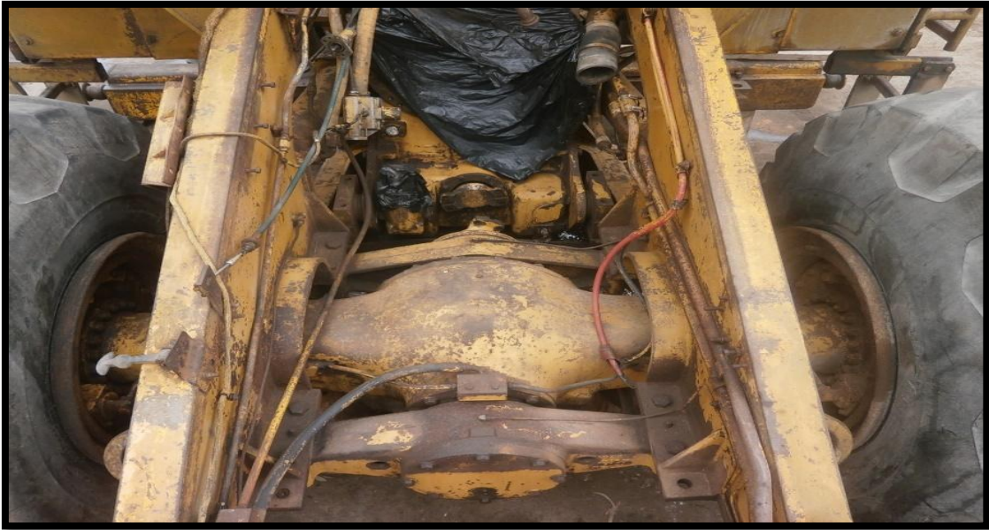
Figura 29: Puente de suspensión trasera cubierto de óxido y fugas de aceite.
