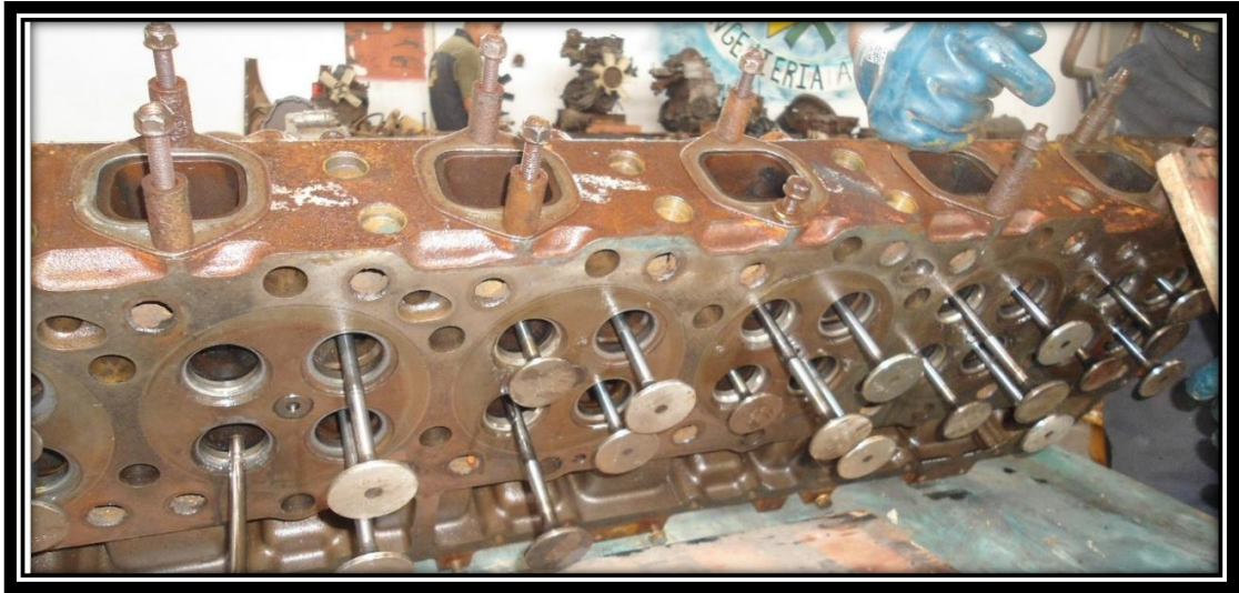
Figura 29: Mantenimiento correctivo de culatas
