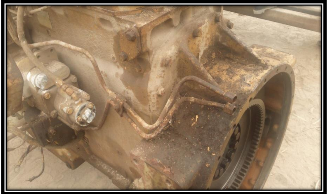
Figura 25: Cañerías de lubricación de Sistema de refrigeración atacadas por fenómeno de corrosión
