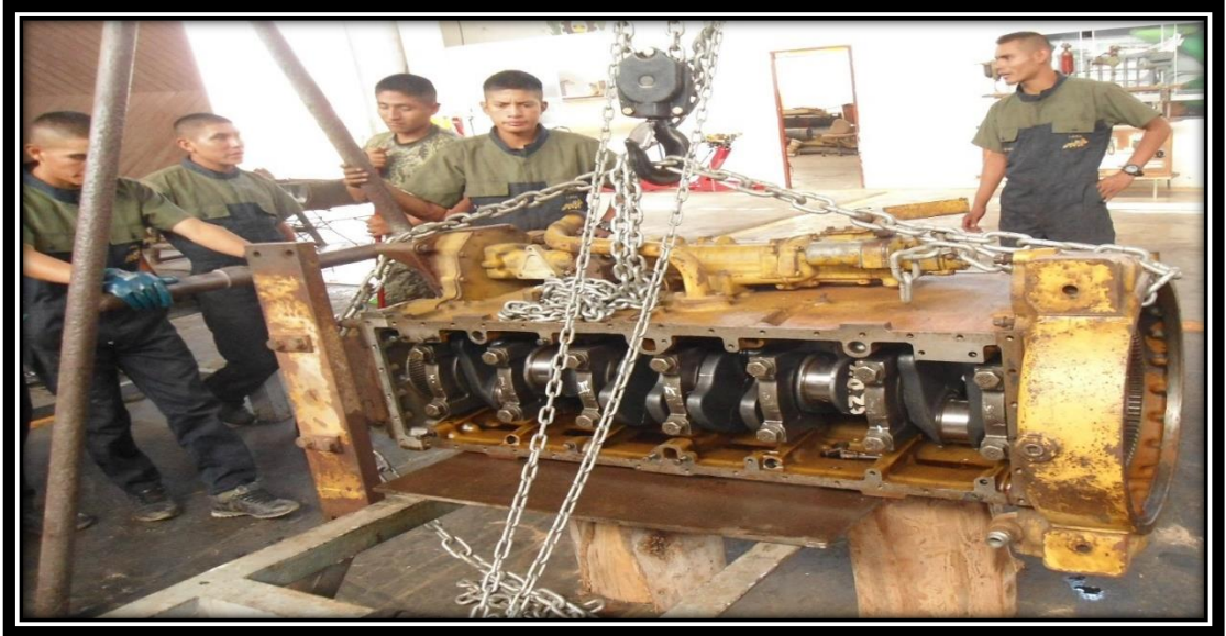
Figura39: Desmontaje de los pistones de la culata o cilindros
