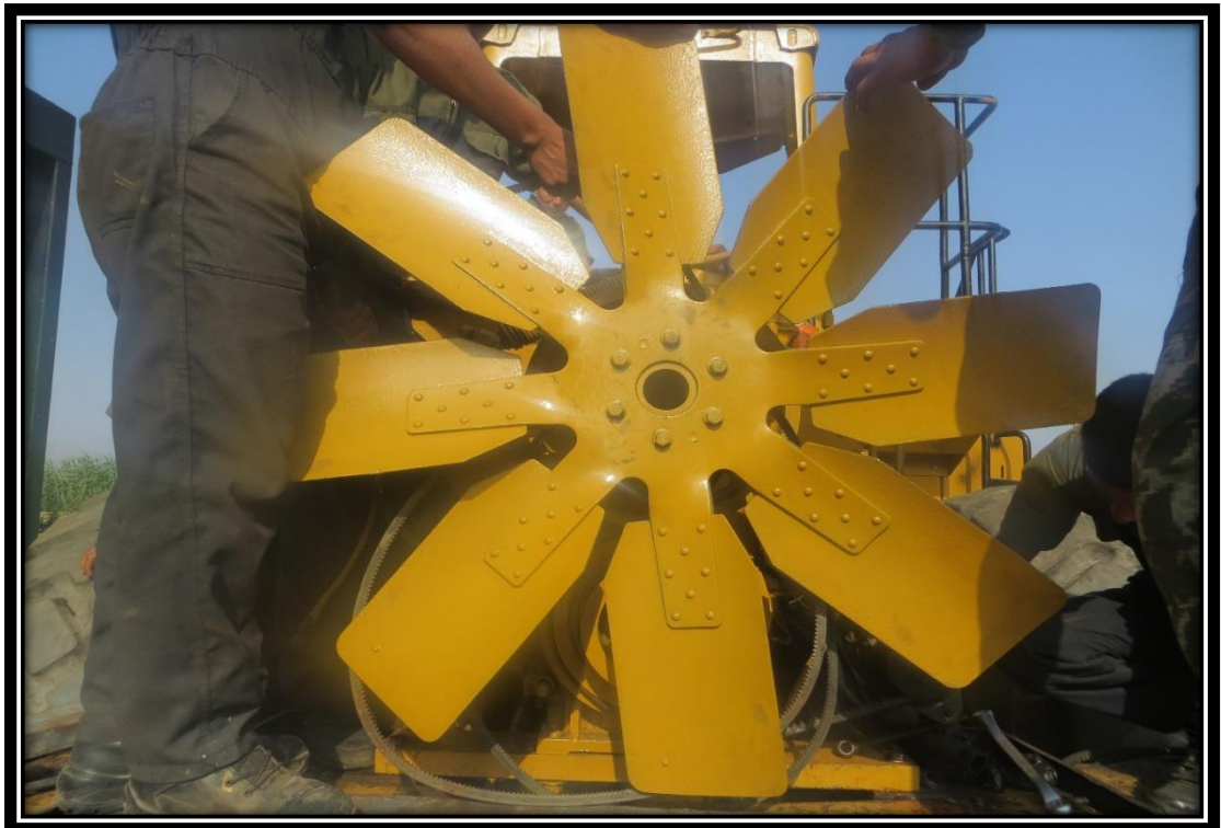
Figura44: Mantenimiento y pintado para el montado del ventilador
