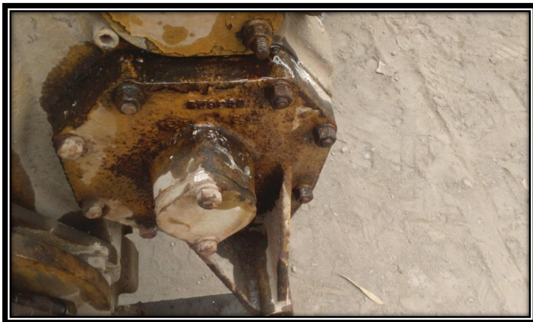
Figura24: Fuga de aceite por sellos de hermitización del Sistema de lubricación
