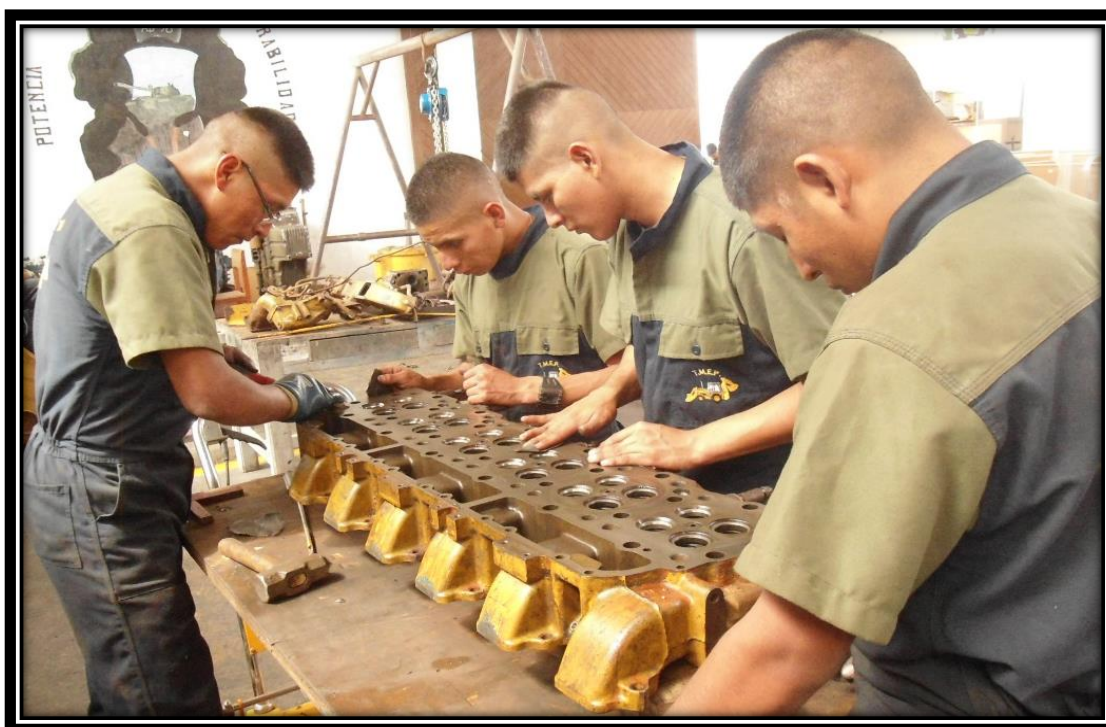
Figura36: Desmontaje de la culata del motor
