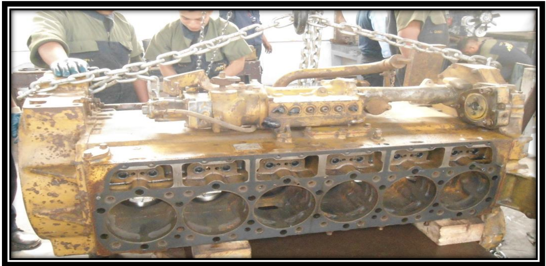
Figura 30: Mantenimiento correctivo de monoblock
