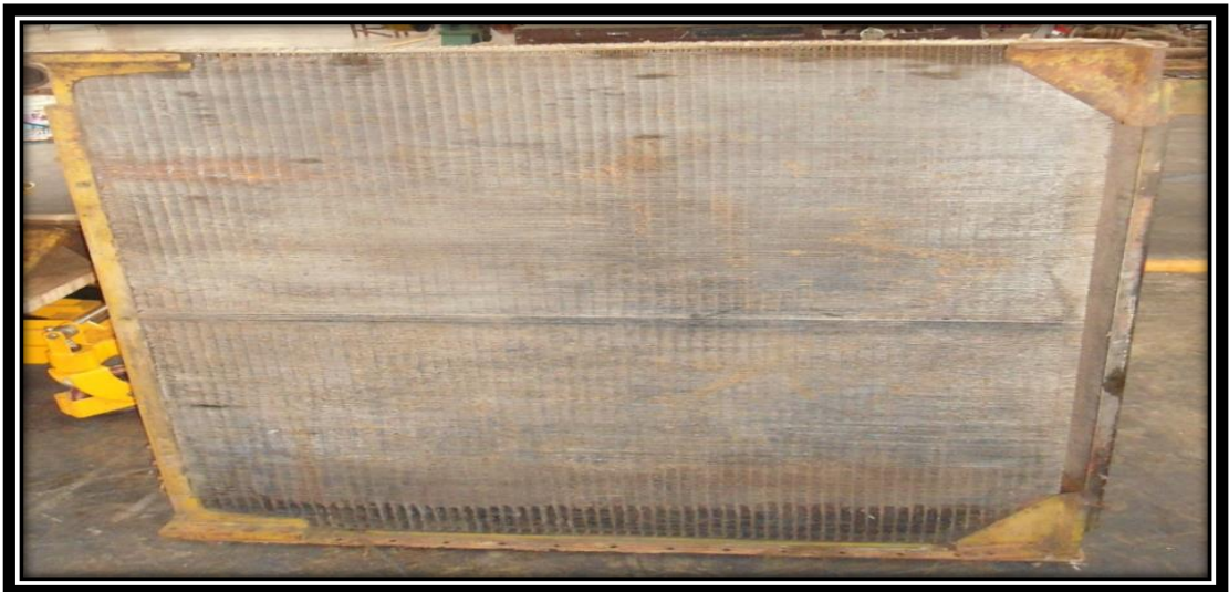
Figura 32: Sondeo de radiador
