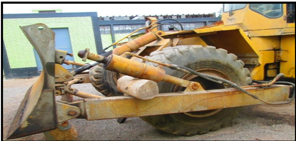
Figura 36. Cilindro de inclinación y de izado con fugas en los sellos del bastago, pines o pasadores desgastados y oxidados, fugas de aceite en el cilindros y mangueras en mal estado
