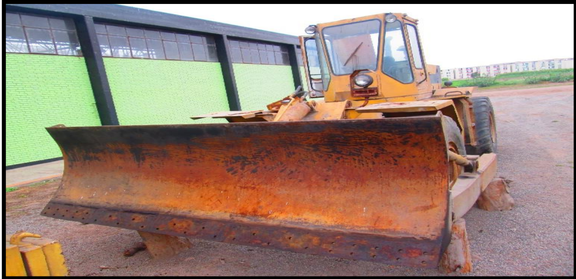
Figura 35. Hoja o lampón oxidado. Sin cuchillas y presenta desgaste y corrosión
