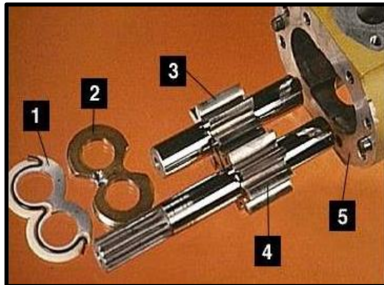
Figura 17. Bomba hidráulica de engranajes desmontada. 1: Sellos, 2: Plancha de presión, 3: Engranaje loco, 4: Engranaje de impresión, 5: Caja.
