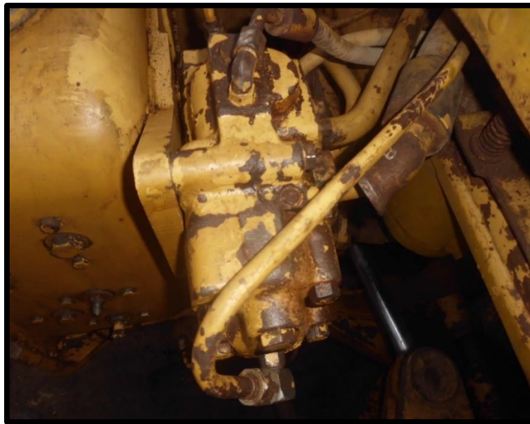
Figura 32. Válvula prioritaria: atascada por partículas extrañas, fugas por sellos
