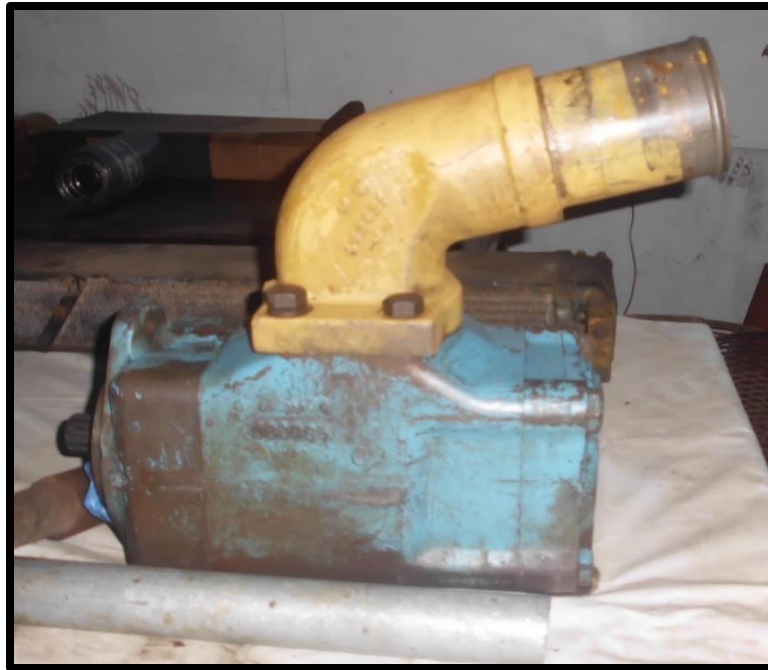
Figura 33. Bomba Hidráulica: fuga de aceite por sellos de hermetización, ruidos extraños.
