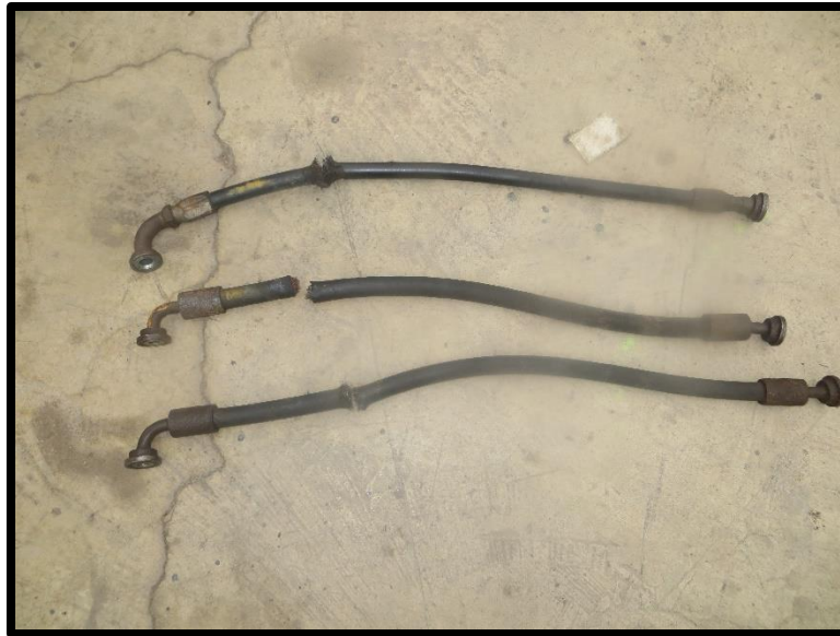
Figura 35. Mangueras 1/2" de alta presión Rotas.
