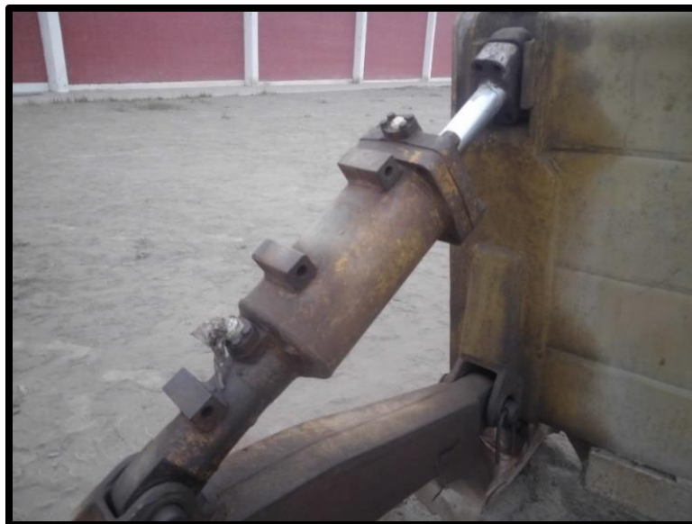
Figura 30. Cilindro de inclinación: fuga por sellos de hermetizarían, desgaste excesivo de los orificios de pasadores del bastidor.
