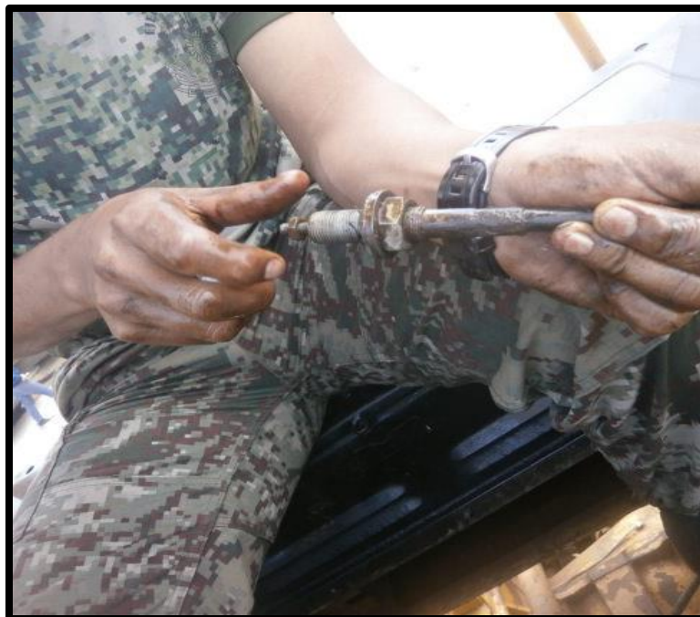
Figura 34. Cable de la palanca de mando rota
