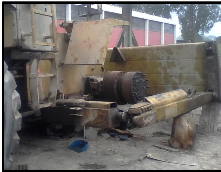
Figura 36. Articulaciones del bastidor del lampón desgastadas.
