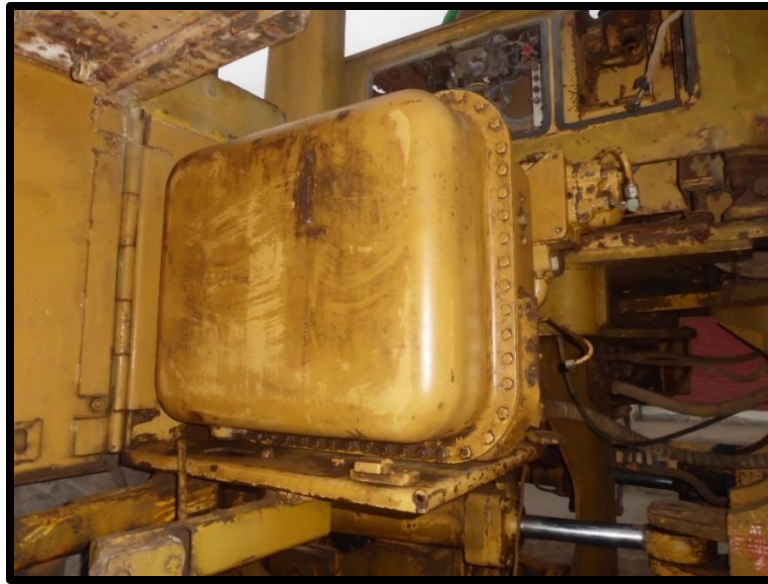
Figura 36: Tanque hidráulico del Sistema de Implementos durante la inspección sensorial.
