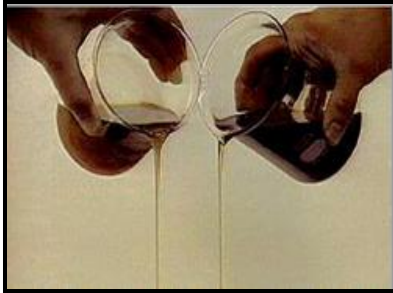
Figura 25. La imagen muestra la comparación del aceite nuevo y el aceite quemado.
