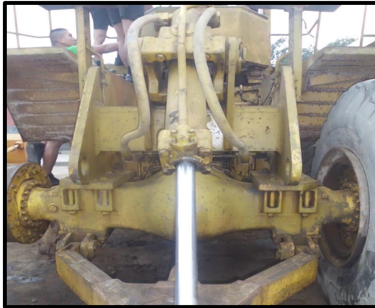
Figura 41: Cilindro de levante con fugas en los sellos.
