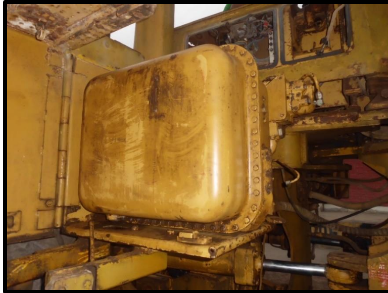
Figura 31. Tanque hidráulico: acumulación de partículas sólidas y suciedad en el interior del tanque, filtro en mal estado, aceite contaminado.
