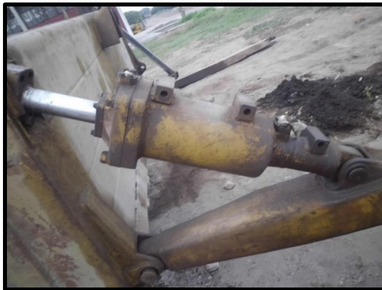
Figura 37: Fotografía del cilindro izquierdo de inclinación del lampón durante la inspección sensorial, el cilindro derecho no se encontraba instalado en el conjunto del lampón.
