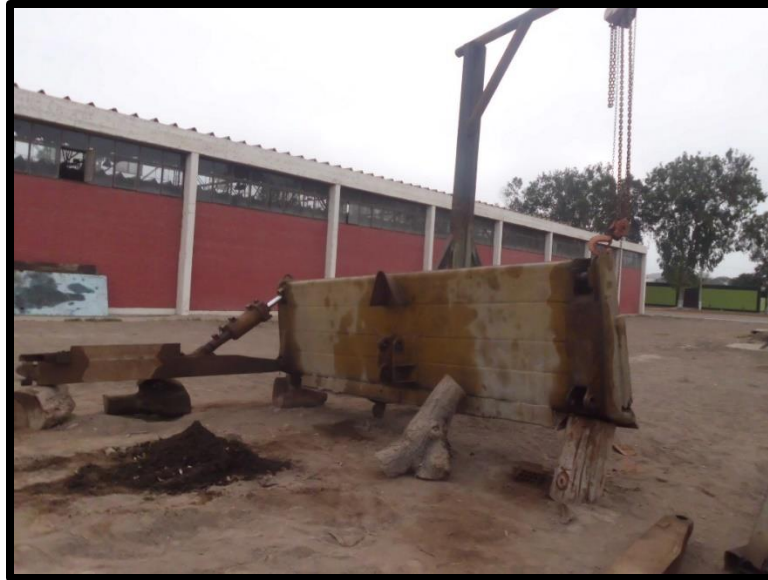
Figura 38: Fotografía del lampón antes de la ejecución del mantenimiento, Brazo derecho desinstalado por completo y sin mangueras de alta presión.
