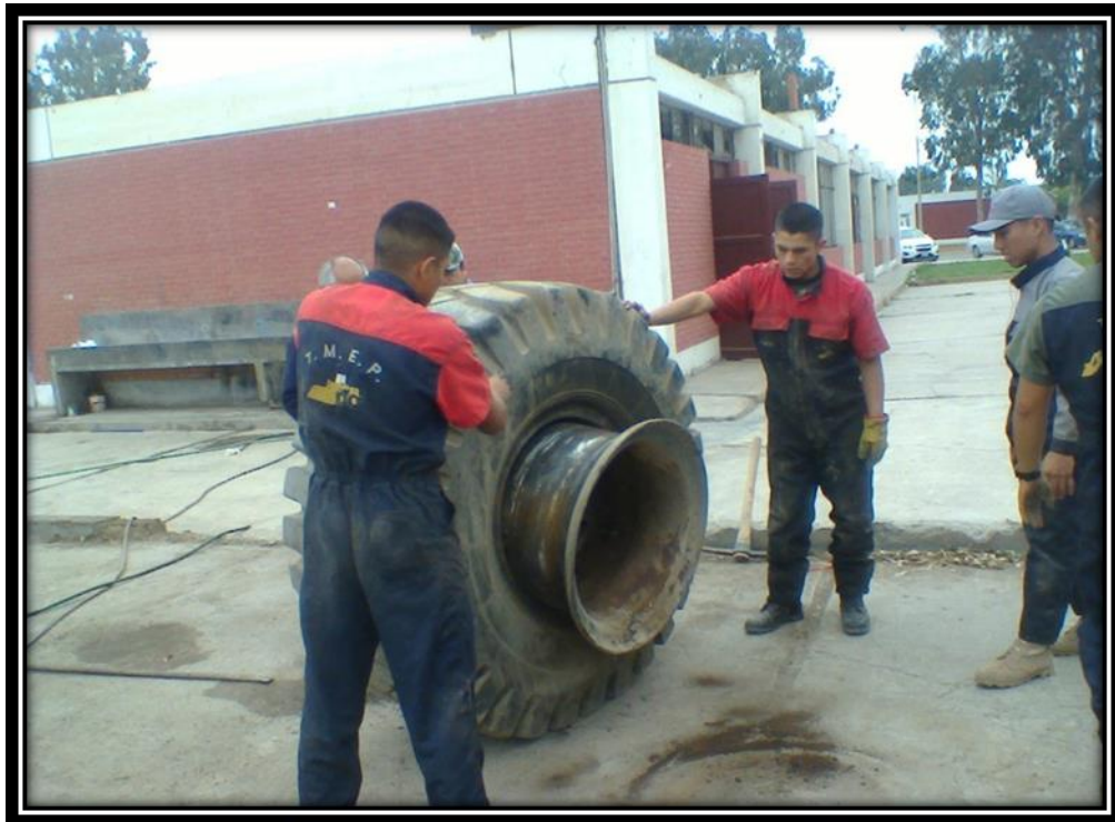
Figura 25: Extracción de la cámara
