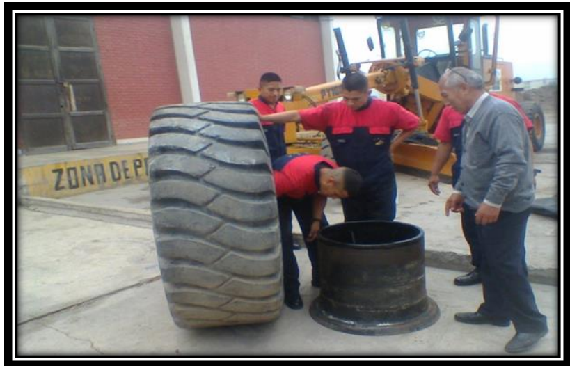
Figura 17: Desmontaje de la llanta
