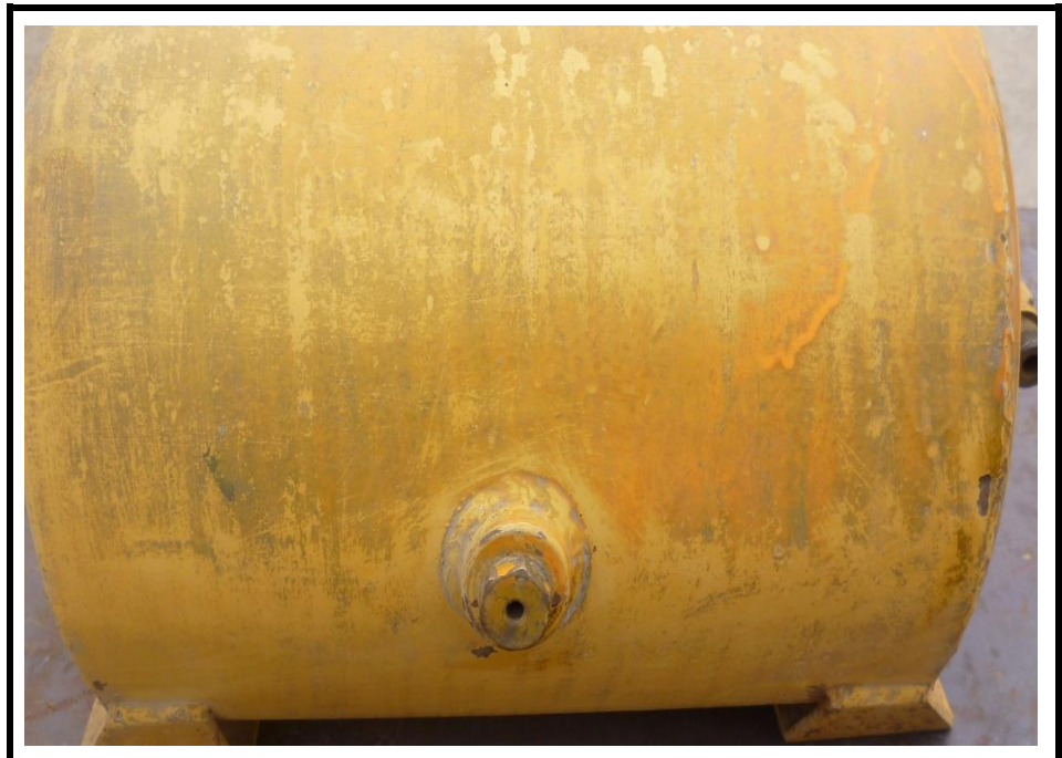
Figura 11. Válvula de Descarga de Agua
