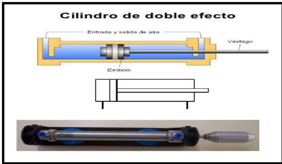
FIGURA18. INTERIOR DEL CILINDRO DE DOBLE EFECTO
