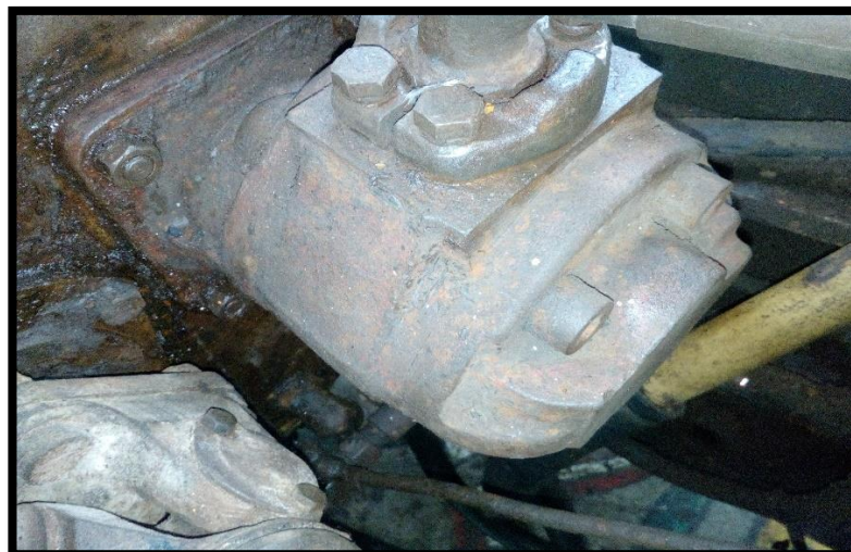
FIGURA 14. BOMBA HIDRÁULICA ENCARGADA DE LA CONVERSIÓN DE FLUIDO.
