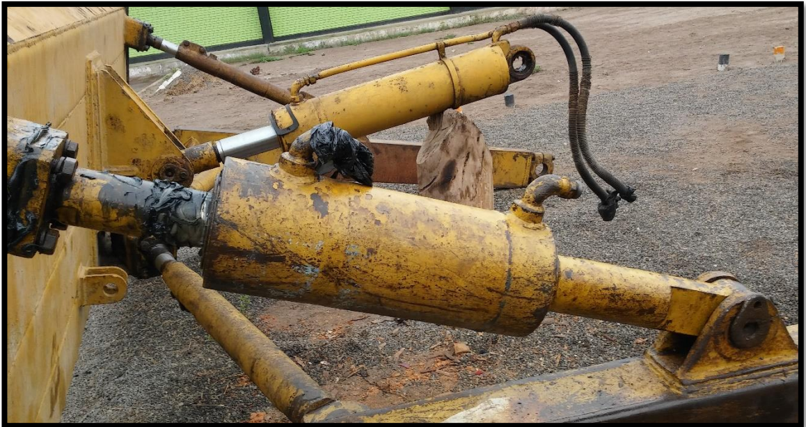
FIGURA 29. CILINDRO IZQUIERDO DE INCLINACIÓN PRESENTA FUGA POR DESGASTE DE SELLOS DE HERMETIZACIÓN Y VÁSTAGO DEL CILINDRO CON PICADURAS POR LA SUCIEDAD Y FALTA DE LUBRICACIÓN.
