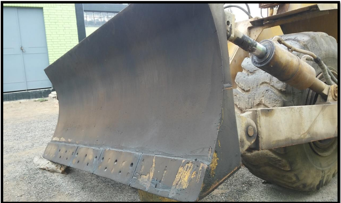
FIGURA 28. LAMPÓN DEL TRACTOR A RUEDAS DURANTE LA INSPECCIÓN SENSORIAL, SIN CANTONERAS Y ESTRUCTURA OXIDADA.
