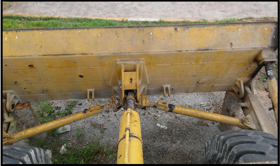
FIGURA 27. CILINDRO DE LEVANTE CON FUGAS EN LOS SELLOS.
