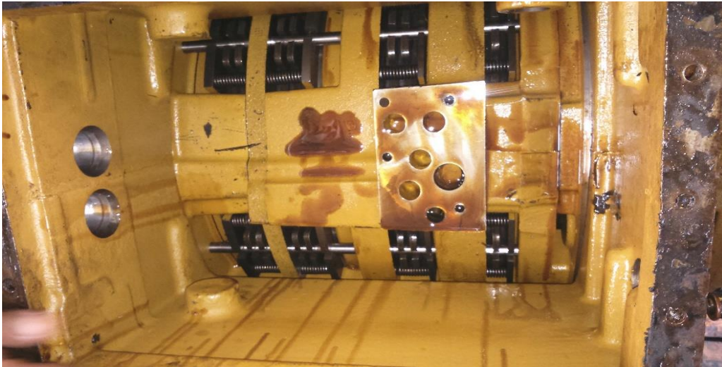
Figura 14 Caja de cambios y aceite contaminado
