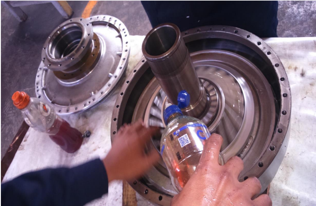
Figura 19 Mantenimiento del convertidor de par
