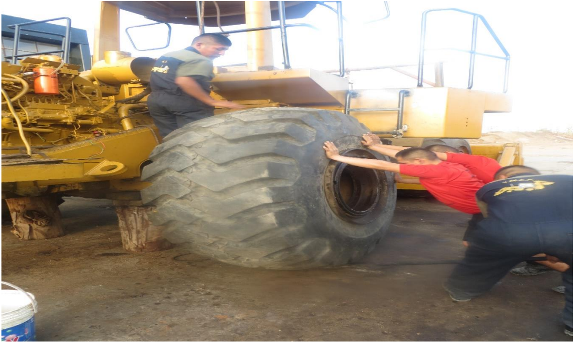
Figura 31 Reparación de mandos finales
