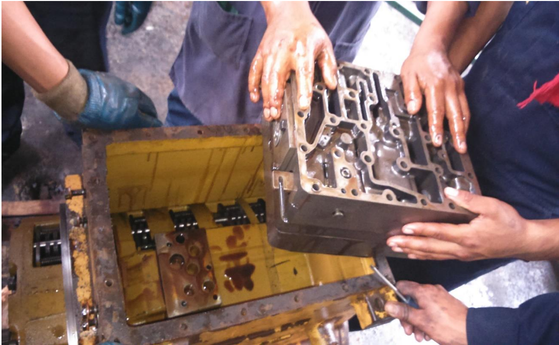
Figura 21 Desmontaje de la caja de cambios
