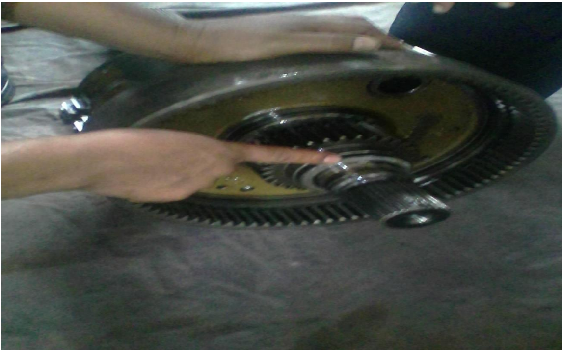
Figura 26 Desmontaje del seguro del eje
