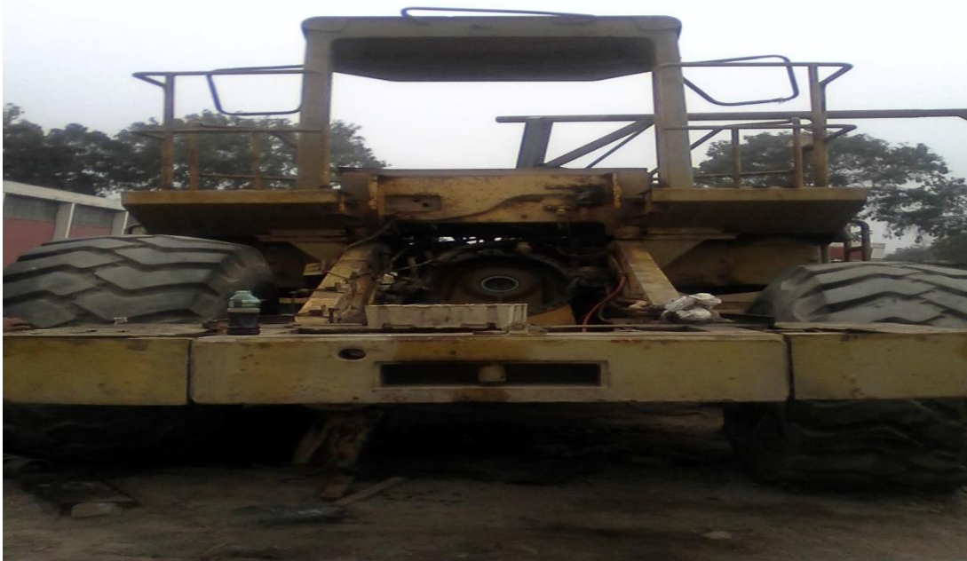
Figura 23 Desmontaje de la caja de transmisión
