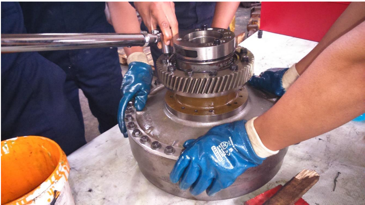
Figura 32 Dando el torque necesario al convertidor de par
