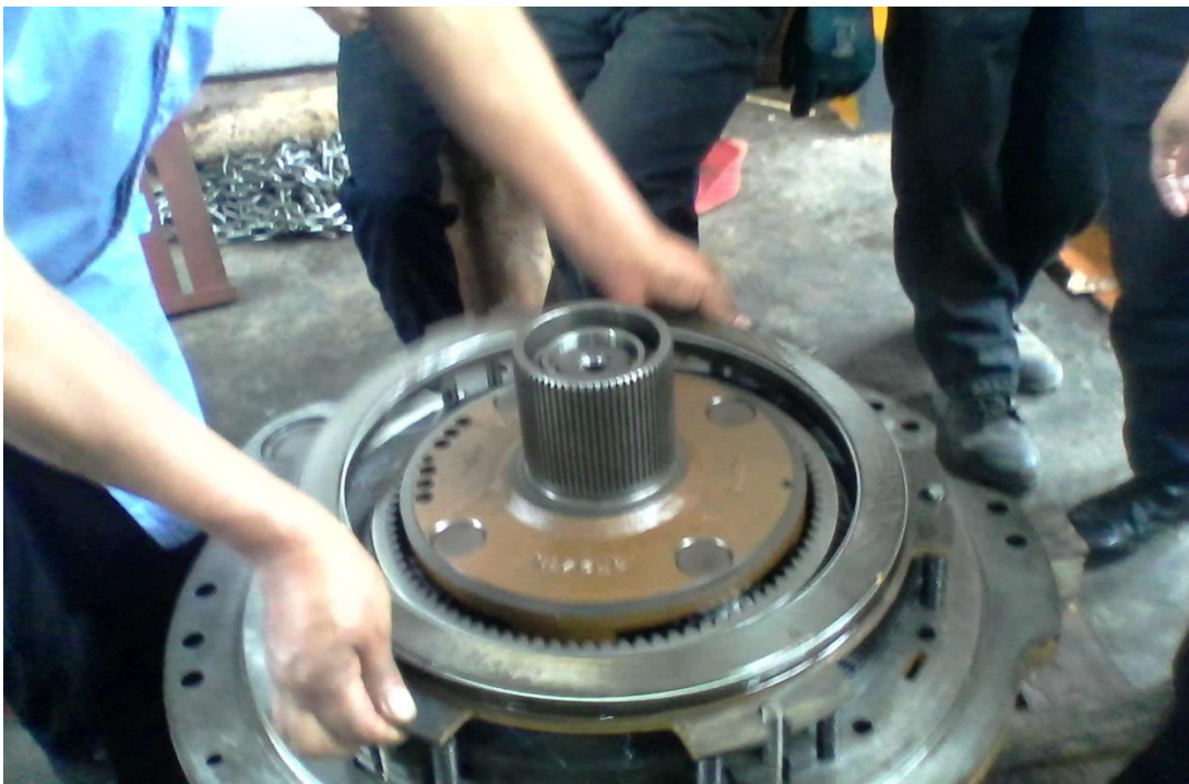
Figura 24 Desmontaje de discos
