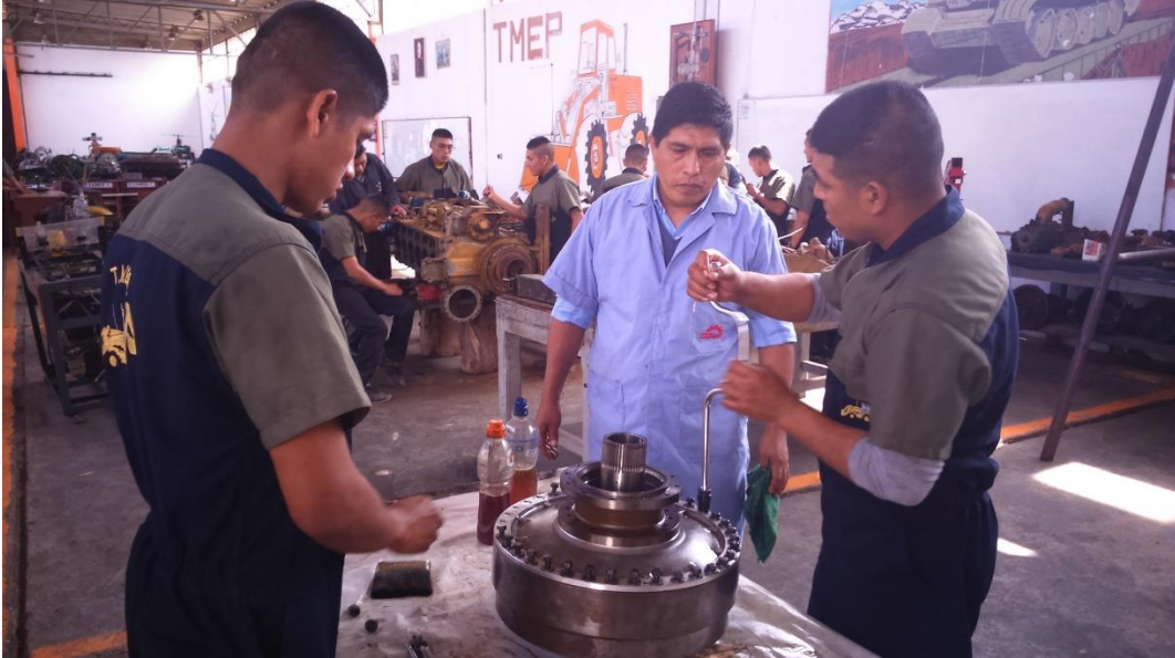
Figura 17 Desmontaje del convertidor de par
