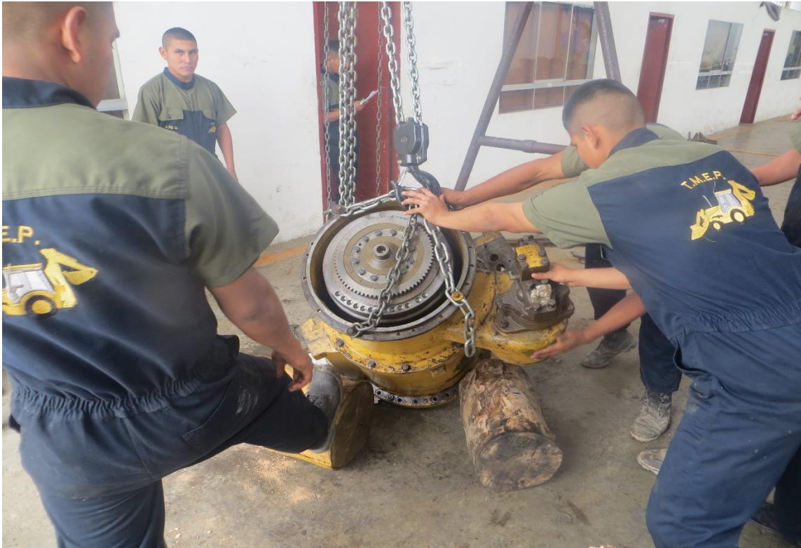
Figura 27 Traslado para montar la caja de transmisión
