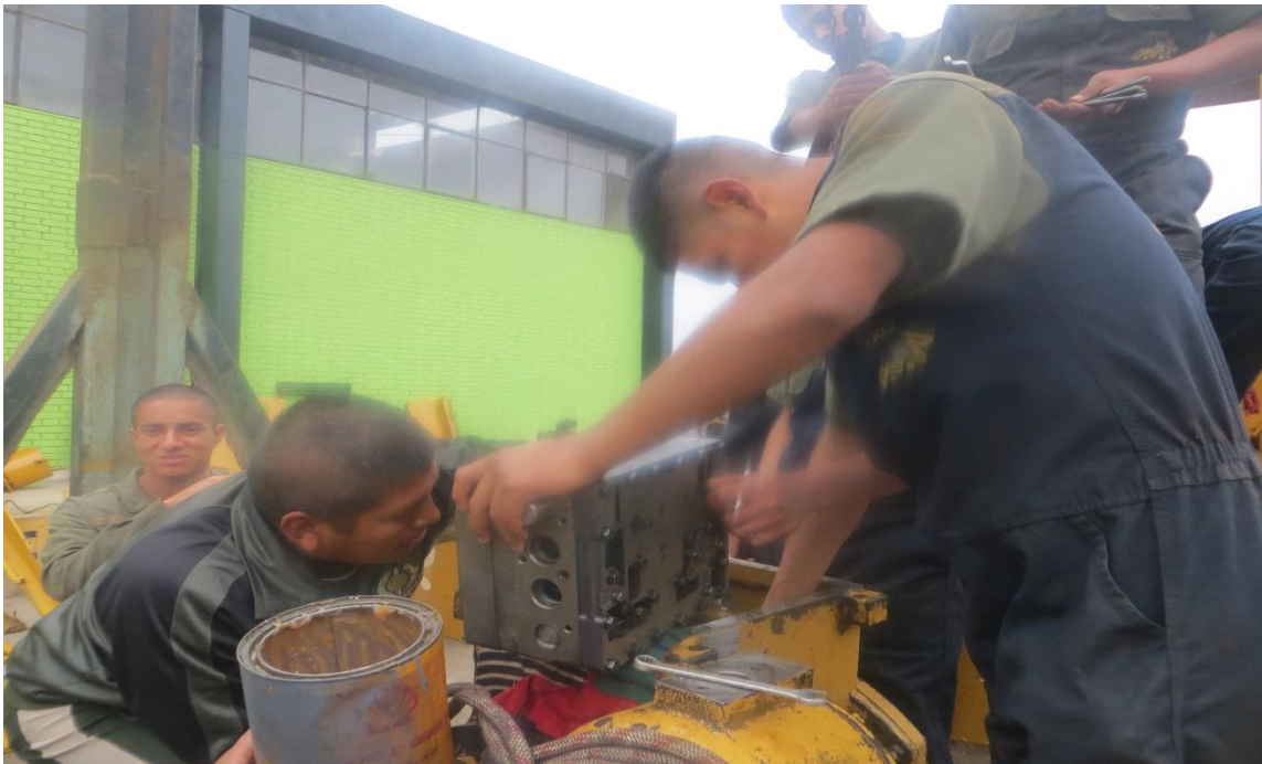
Figura 36 Montaje de la caja de válvulas
