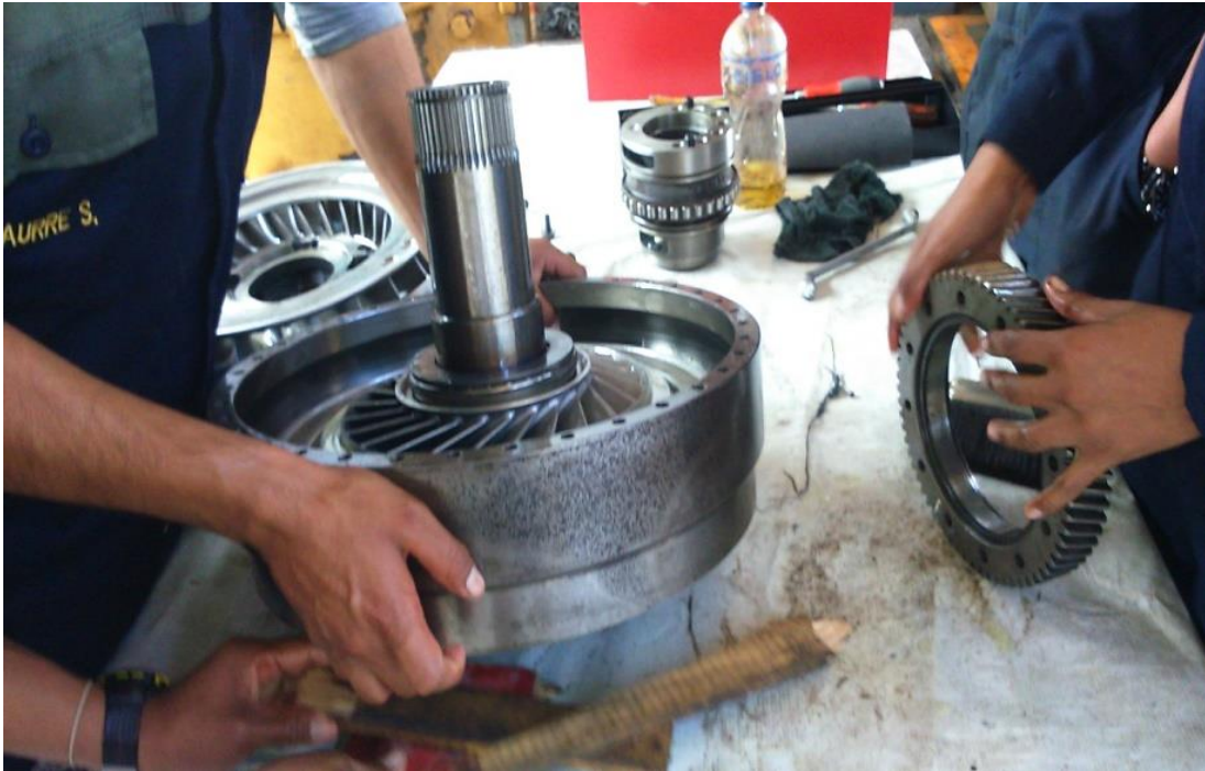
Figura 04 Desmontaje del convertidor de par
