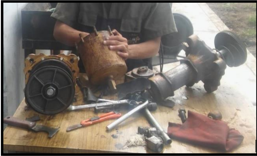
Figura 20. Mantenimientos a los servos de sistema de frenos.
