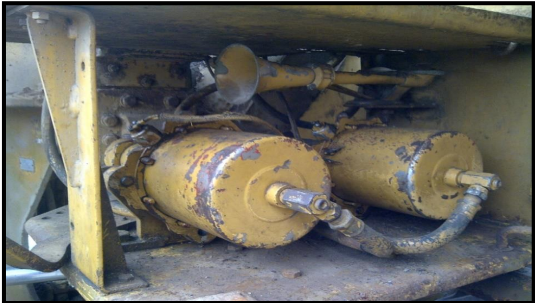
Figura 05. Acumulador o serbo neumático
