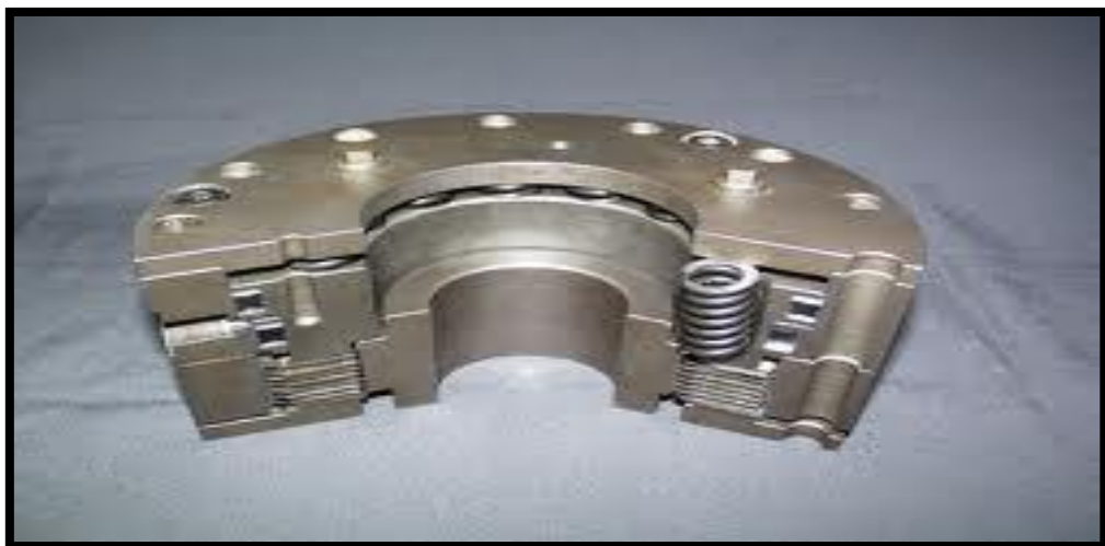
Figura 07. Frenos de Disco Múltiples
