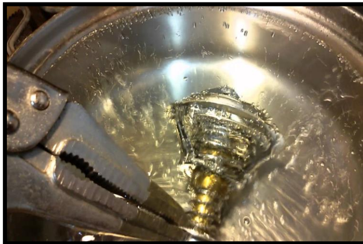
Figura 19. Termostato en agua hirviendo
