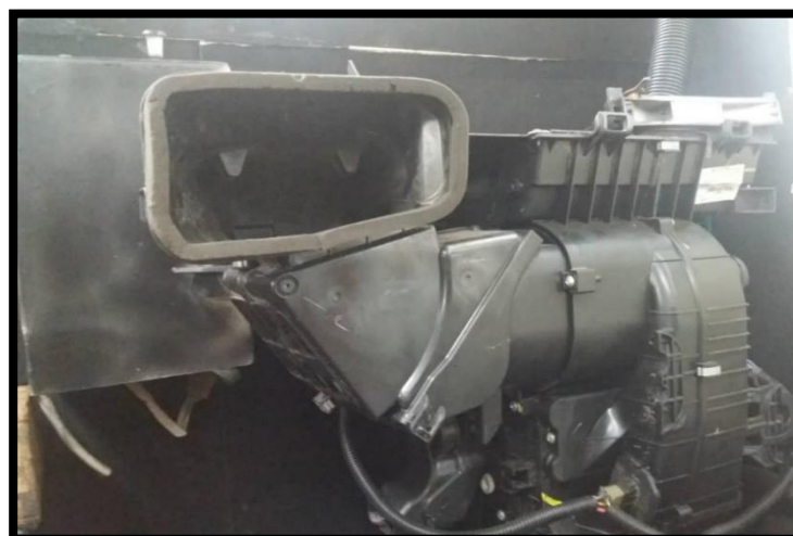
Figura 12. Toma de Fuerza del Sistema de Aire Acondicionado (Evaporador y válvula de expansión)
