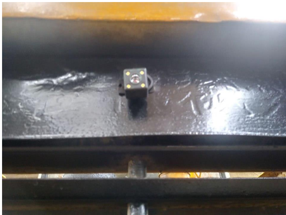
Implementación cámara de retroceso en la parte superior del radiador.
