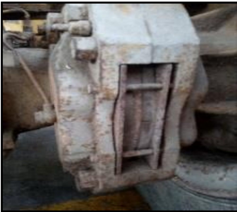
Figura 23 CÁLIPER: Ataque corrosivo de la estructura.
