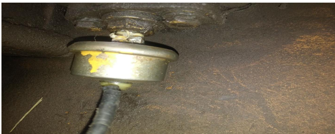
Figura 13: Sensor de Presión de Aceite del Tractor a Ruedas TL210A
