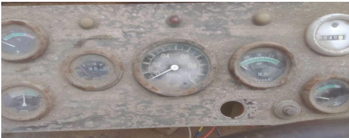
Figura 12: Tablero de Instrumentos del Tractor a Ruedas TL210A en mal Estado
