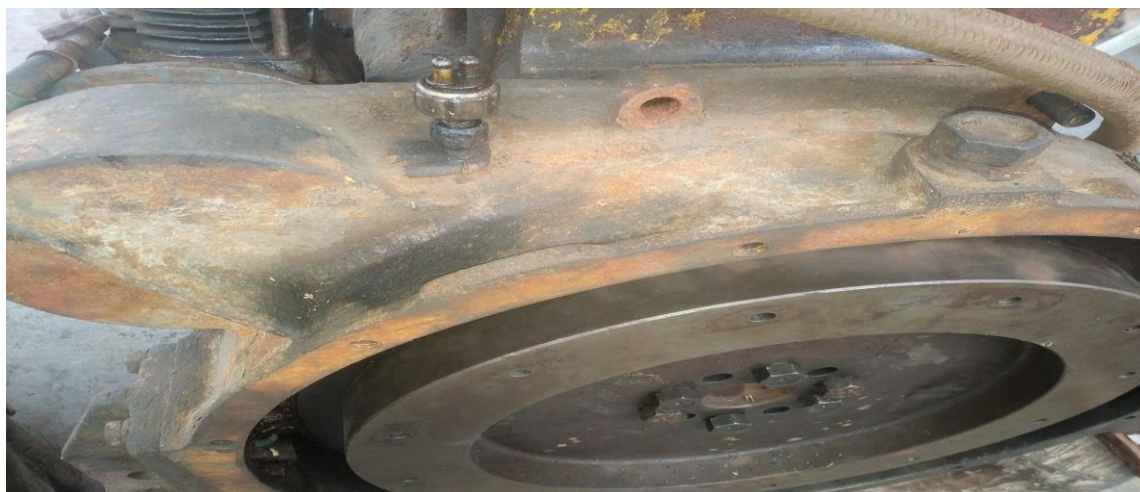
Figura 14: Sensor de Revoluciones Del Motor en el Tractor a Ruedas TL210A
