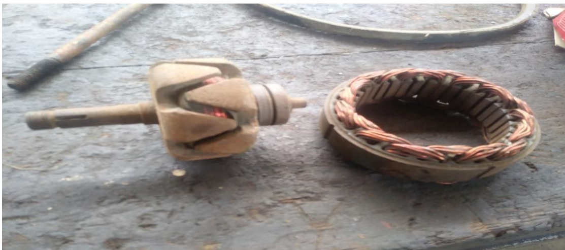
Figura 15: Rotor del Alternador del Tractor a Ruedas TL210A
