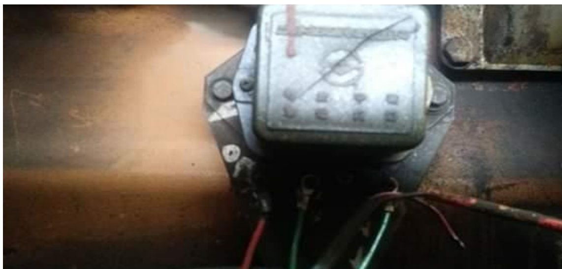
Figura 18: Relay implementado en el Tractor a ruedas TL210
