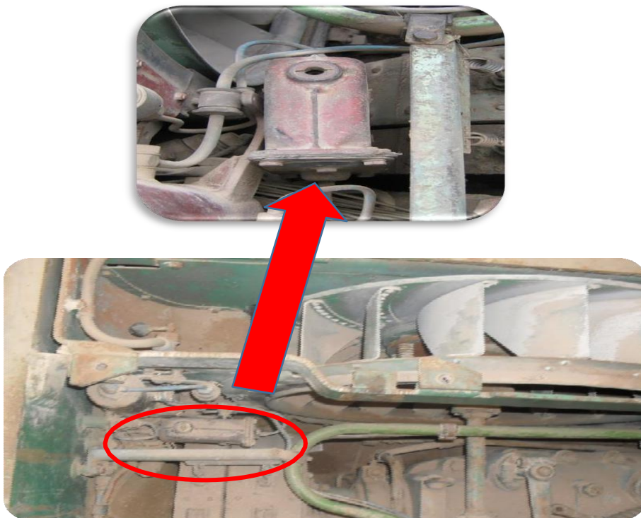
Figura 10. Regulador Automático de Presión ADU-2C en el tanque; (fuente: Autoría Propia).
