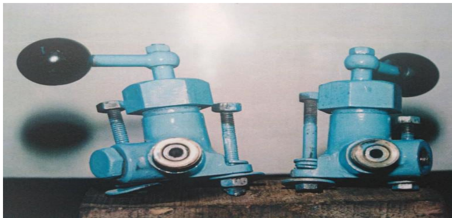
Figura 18. Grifo de toma de Aire; (fuente: Autoría propia).
