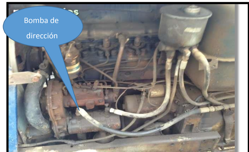
Figura 5. Bomba de dirección Fuente: Autoría Propia
