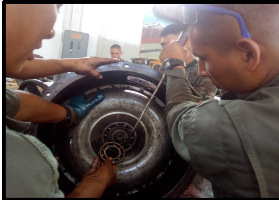
Fotografía 5. Reparación y mantenimiento de seguro de bomba de transmisión
