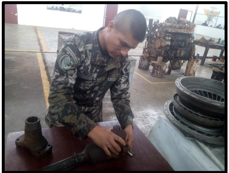
Fotografía 14. Mantenimiento correctivo de del cardan
