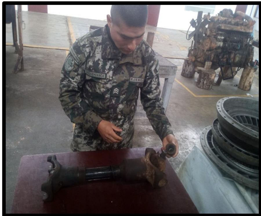
Fotografía 12. Mantenimiento correctivo de del cardan
