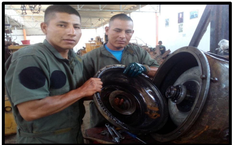
Fotografía 4: Mantenimiento correctivo y desmontaje, reparación del convertidor de par
