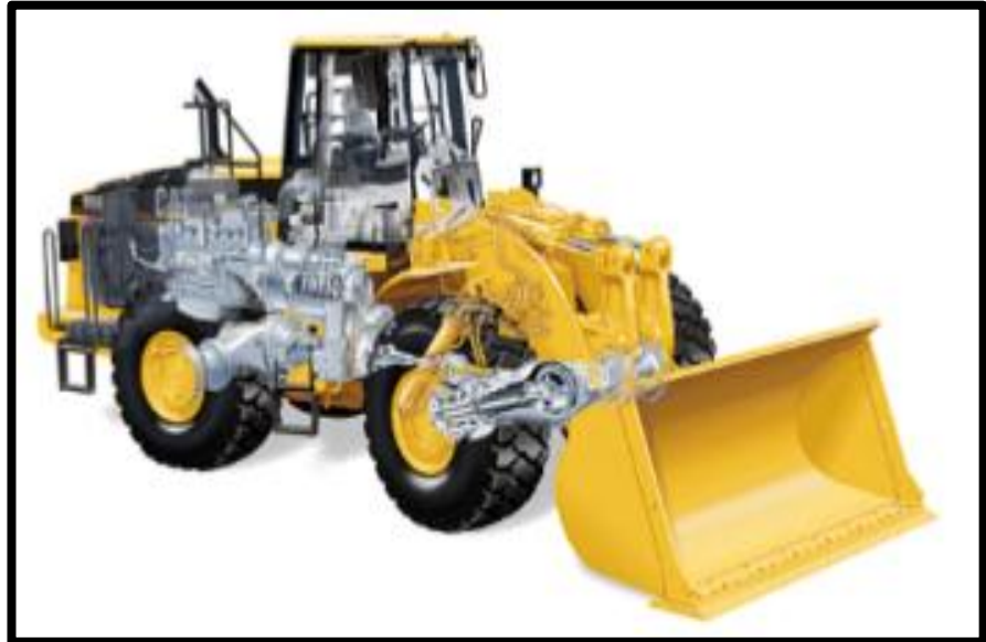
Figura 1. Sistema Transmisión de Fuerza (FERREYROS, 2005)
