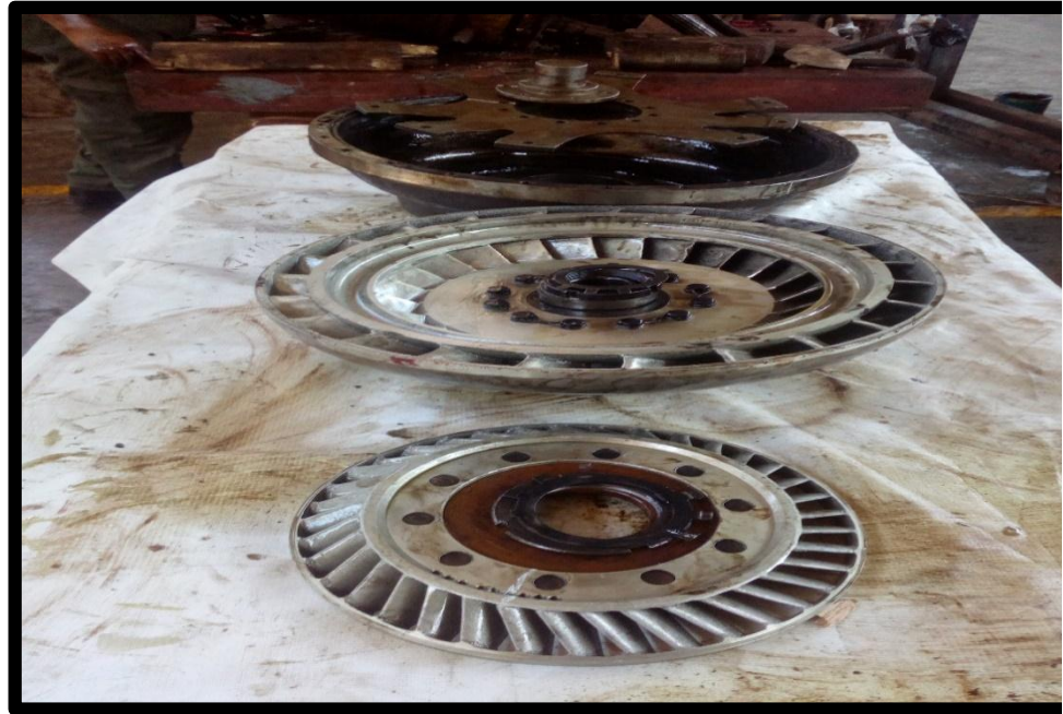
Figura 7. Inspección y lavado de la bomba y turbina, estator
