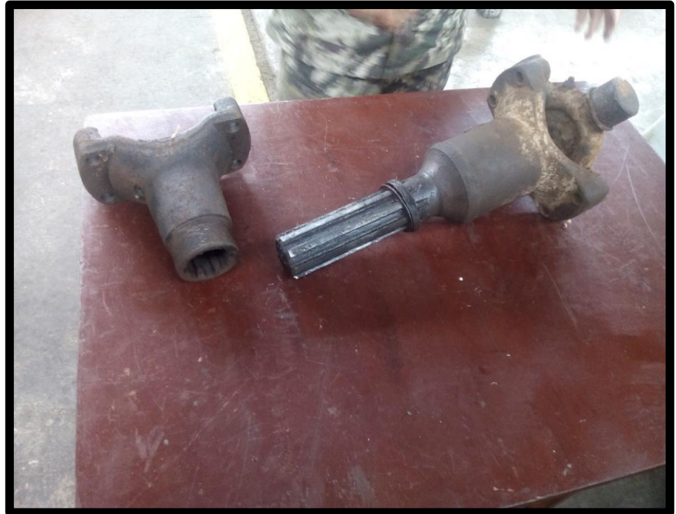
Fotografía 13. Mantenimiento correctivo de del cardan y desgastes
