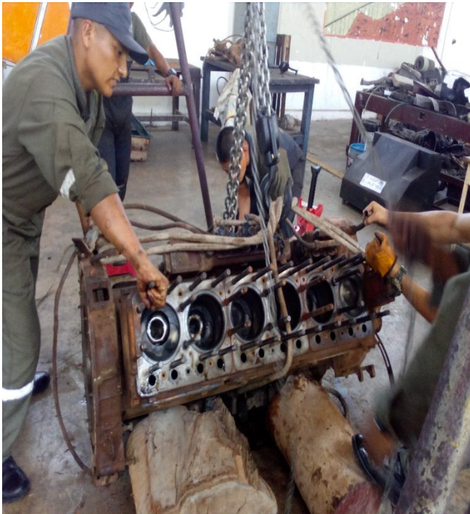
Fotografía 5: Mantenimiento correctivo del monoblock
