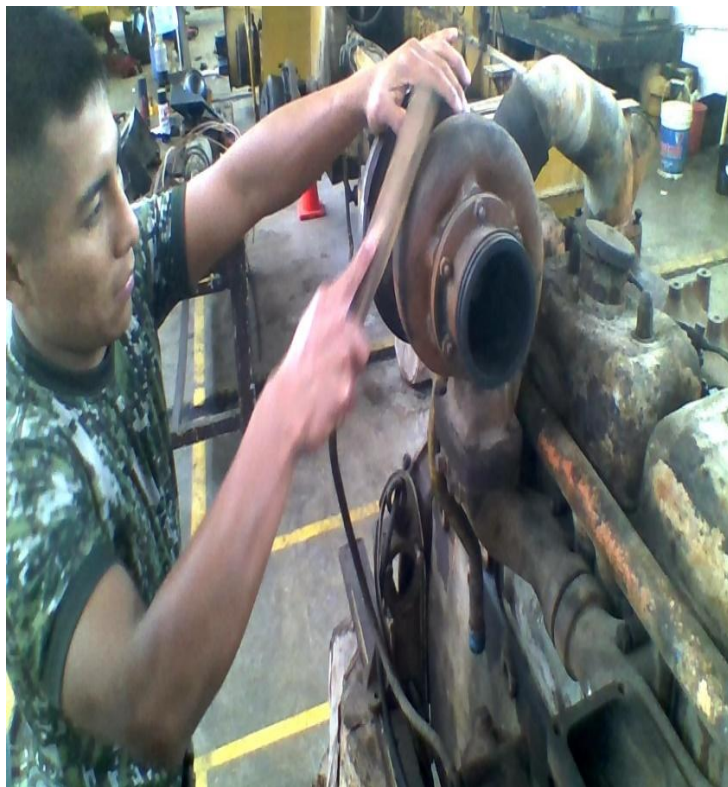
Fotografía 10: Mantenimiento correctivo de múltiple del escape
