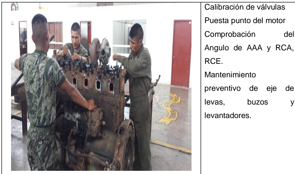
Fotografía 12: Mantenimiento correctivo del Sistema de distribución
