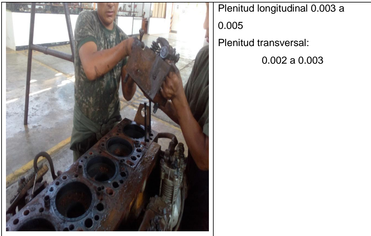
Fotografía 4: Inspección y control de parámetros: medición de la planicidad de la culata
