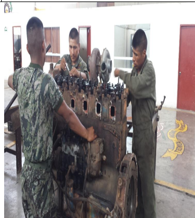
Fotografía 3: Desmontaje de tren de válvula: balancines eje de balancines, válvulas, resortes y seguros.
