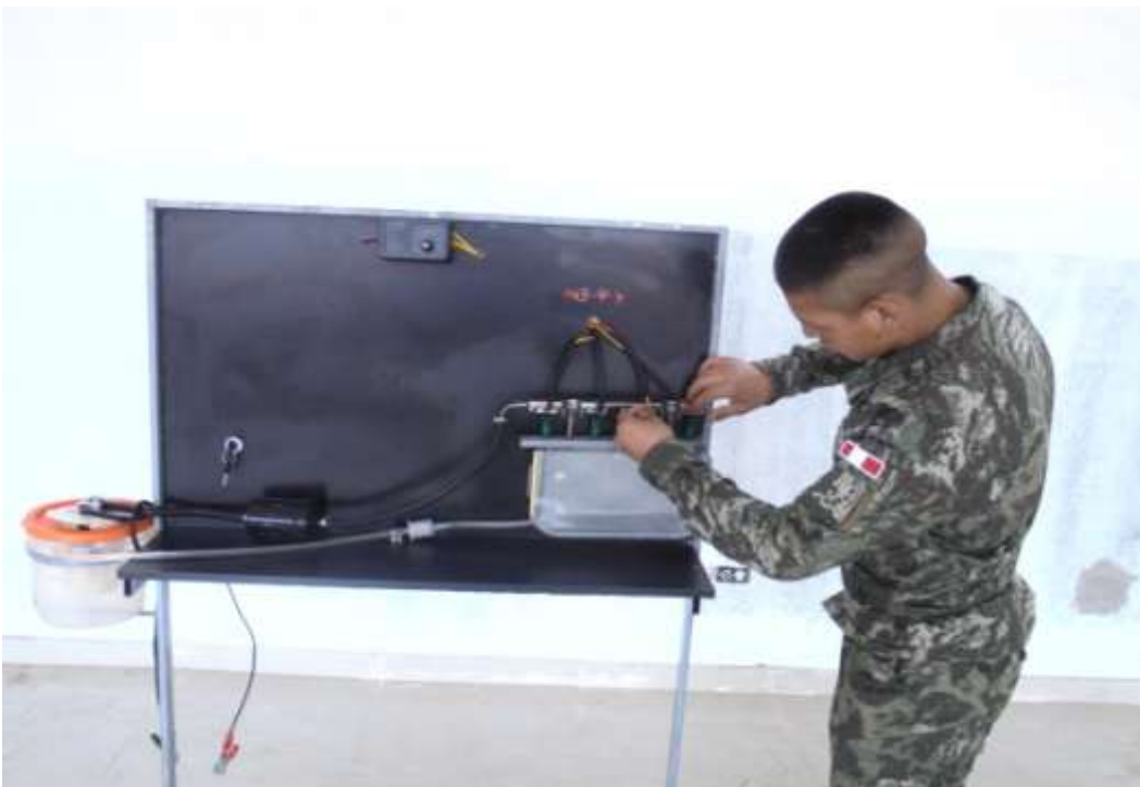
Asiendo la prueba de los inyectores.
